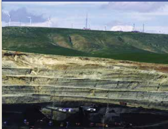
شکل ۸: معدن زغال‌سنگ Pavlovka روسیه که از خاکستر زغال‌سنگ آن (با محتوای REE ۹۰۰ تا ۸۴۰۰ ppm) عناصر REE استحصال می‌شوند.
